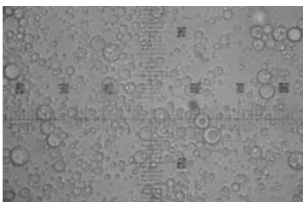
图 3 W/O/W 型人参总皂苷复乳的类型鉴别(10×45 倍)
